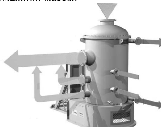
Рис. 4. Технологические потоки у станки OptiScreen FS
