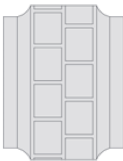
Рис. 3. Прямые лопасти в шахматном порядке
