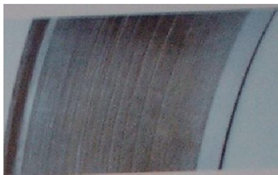
Рис. 3. Абразивный износ по окружности дорожки тел качения
