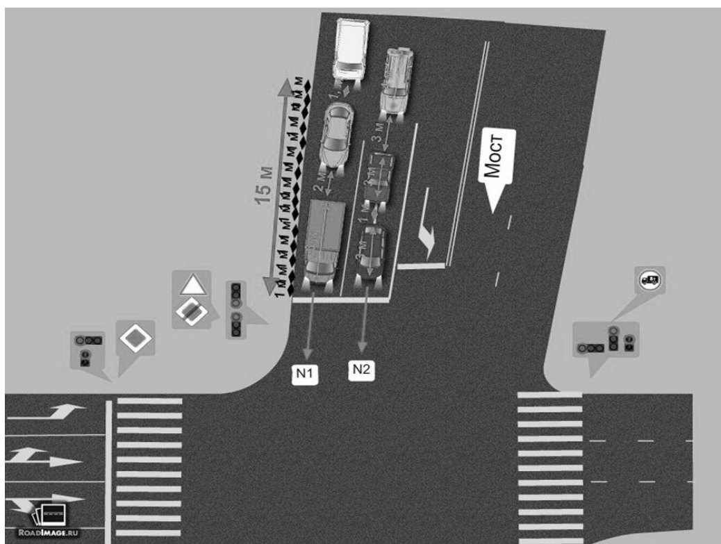
Рис. 1. Схема определения расстояния между транспортными средствами
