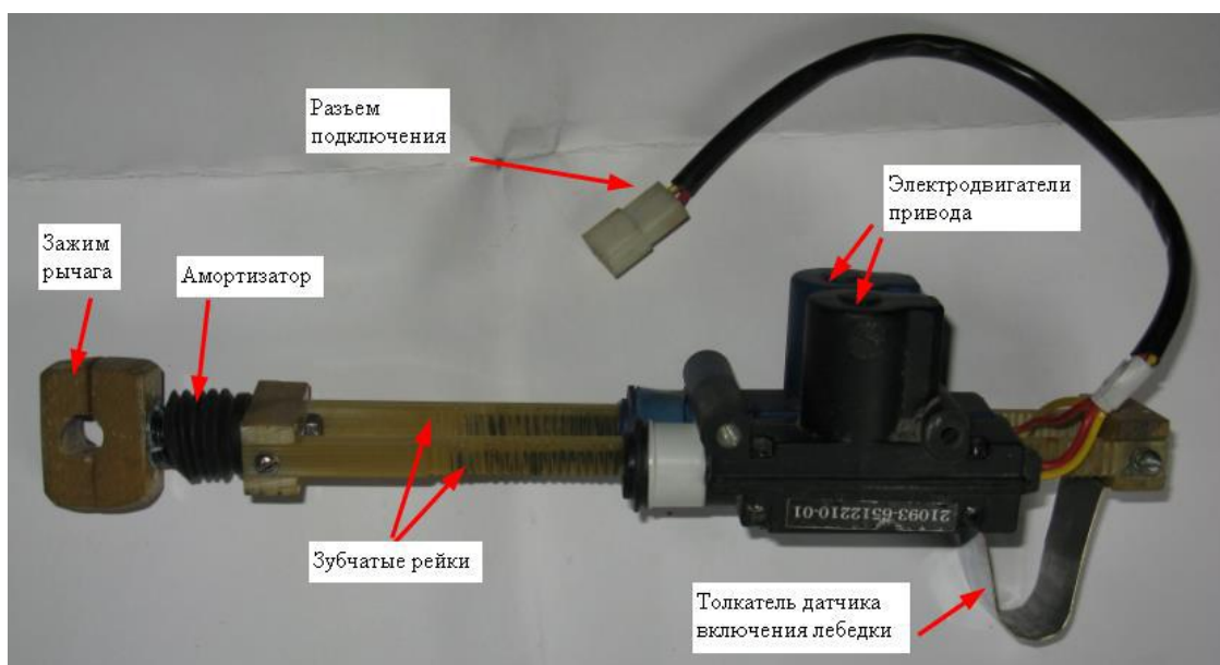
Рис. 2. Привод включения лебедки с параллельно соединенными рейками
