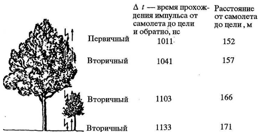
Рис. 4.3. Схема множественного отражения лазерного импульса от лесного полога высотой 18 м (Nelson et al., 1988).
