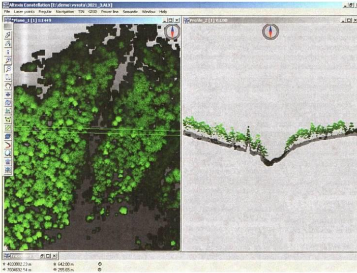
Рис. 4.12. Синтезированные лазерно-локационные изображения структуры лесного покрова и рельефа местности в формате представления лесорастительных и топографических данных программного комплекса Altexis 2.0 (Данилин, Фаворская, 2011).
