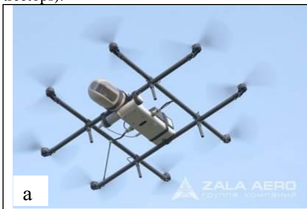
Рис. 4.7. Паукообразный беспилотный вертолет (автокоптер) в полете на Острове Барро Колорадо (Панама) в июне 2013 года, Смитсоновский институт тропических исследований (слева) и его снимок растительного покрова в Коста Рике (справа) ( http://www.scientificamerican.com/article.cfm?id=camera-equipped-autocopters-map-forest-treetops ).
